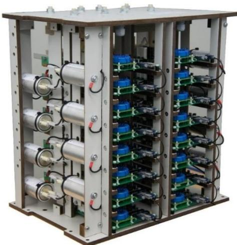
Abbildung 10: IPSS Einsatz in einem Crowbar-Schalter
