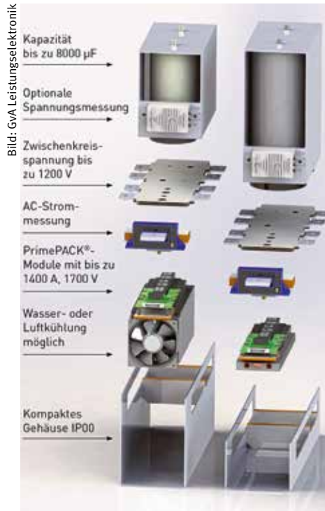
Bild 2: Aus diesen Elementen besteht ein IGBT-Halbbrücken-Baustein, in dem optional auch ein Spannungswandler seinen Platz hat.
